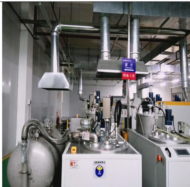
整改后在灌注机出口上方设置集气罩
